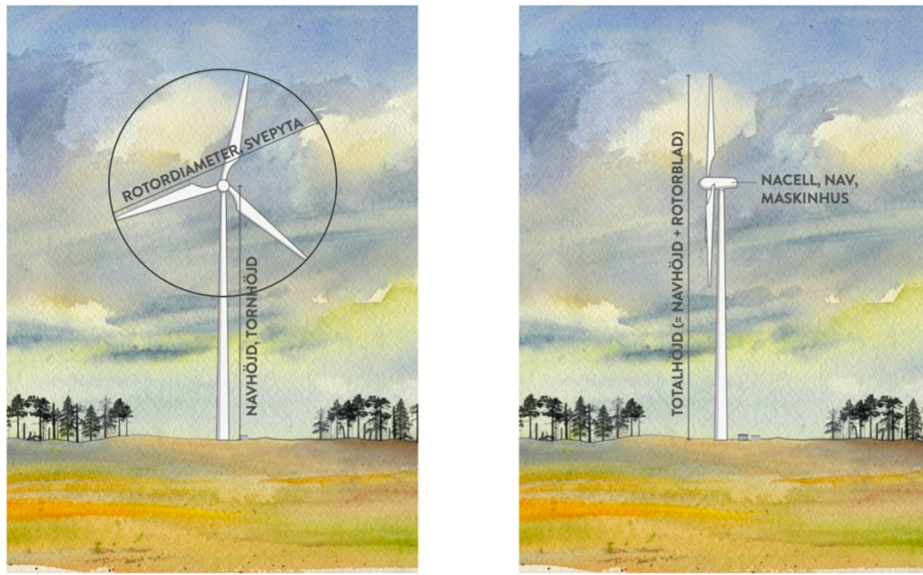
Figur 3. Vindkraftverkens principiella utformning.
