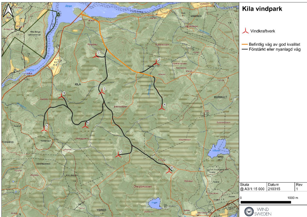
Figur 3. Preliminär utformning av servicevägar.
